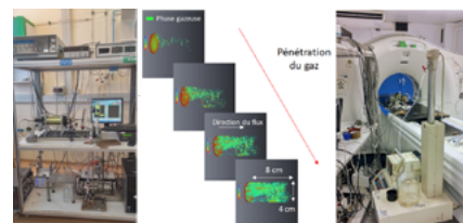
Ensemble expérimental pour la mesure et l'observation combinées de la perméabilité de milieux poreux.
